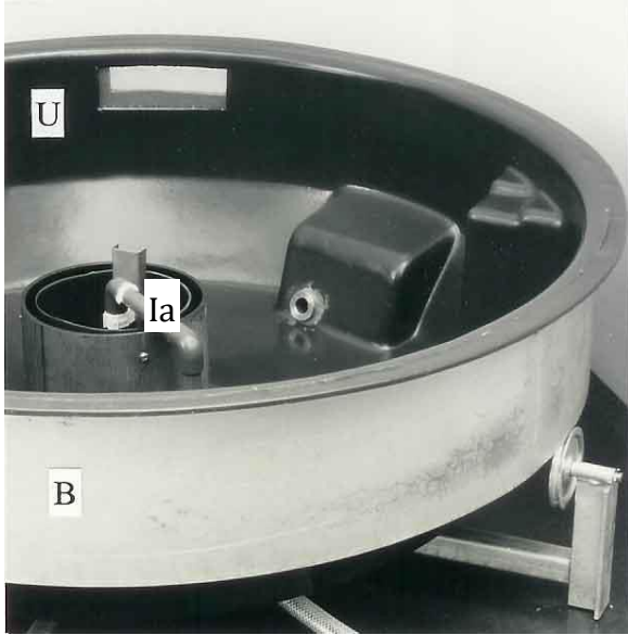
Kuva 3. Imuputken (Ia) kulma paikallaan
